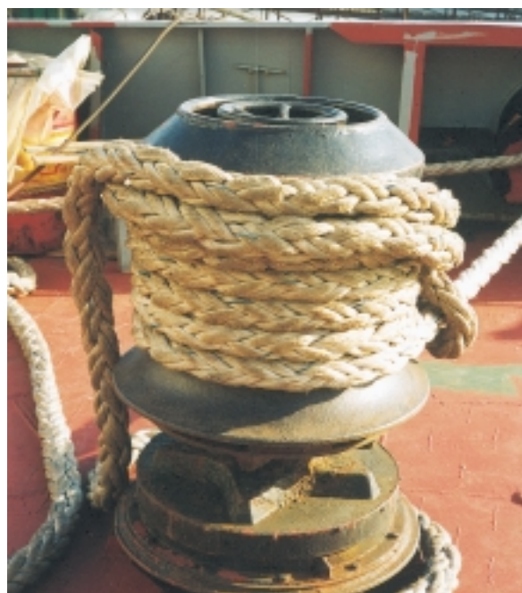
Εικόνα 12.20: Εργάτης άγκυρας (capstan) τοποθετημένος στη πρύμνη για τον χειρισμό των σχοινιών
