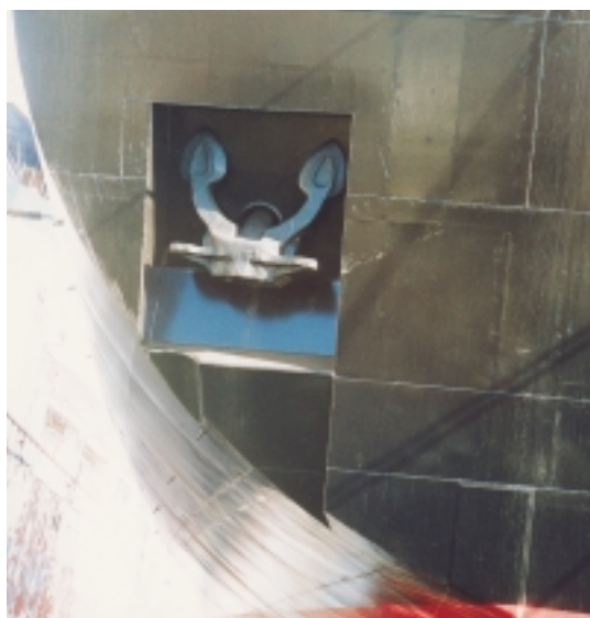
Εικόνα 12.10: Πρυμνιά άγκυρα στη θέση ασφάλισής της
