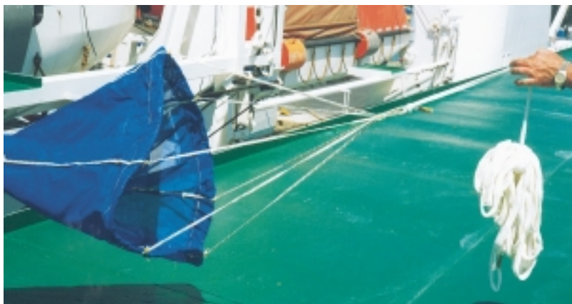
Εικόνα 12.8: Πλωτή άγκυρα (sea anchor)
