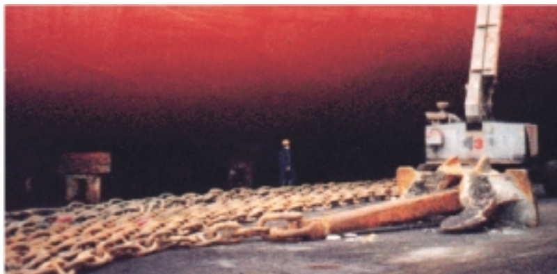
Εικόνα 12.16: Επιθεώρηση και δοκιμή της καδένας
