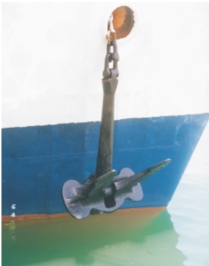
Εικόνα 12.3: Αστυπη άγκυρα «μαϊναρισμένη» και έτοιμη για αγκυροβολία
