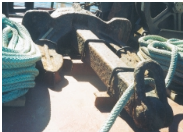
Εικόνα 12.9: Εφεδρική άγκυρα ασφαλισμένη στη θέση της πάνω στο πρόστεγο του πλοίου
