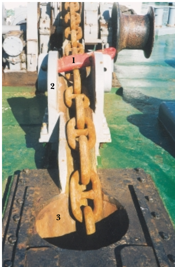
Εικόνα 12.15: Πέδιλο ολίσθησης 1. Πείρος (καστάνια) 2. Πέδιλο ολίσθησης 3. Οφθαλμοί (όκια)
