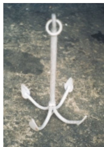
Εικόνα 12.7: Τετράχειλος άγκυρα (τεσσαροχάλη)
