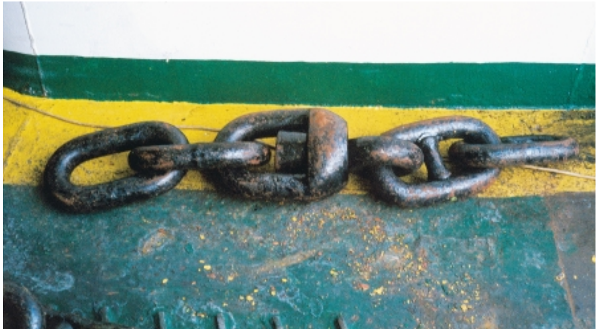
Εικόνα 12.17: (α) Στρεπτήρας (στριφτάρι) σύνδεσης άγκυρας με την αλυσίδα (καδένα)
